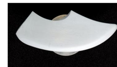
表面研磨を行い、塗装を行います。モデル表面の積層段差を研磨することによってなめらかな仕上がりとなります。また、真空注型マスターとしてもご使用いただけます。
