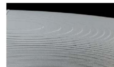
表面研磨をせずに塗装を行います。短納期・低コストで着色が可能ですが、モデル表面に積層段差が残ります。
