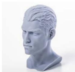
サイズ:33 × 44 × 60 mm / 材料:GrayPro / 積層ピッチ:0.05 mm
